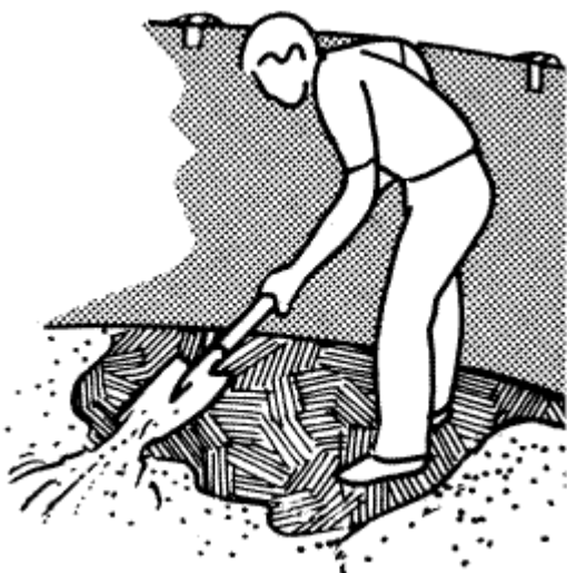
26. Etaler le sable pour couvrir la totalité de la surface du bassin.
